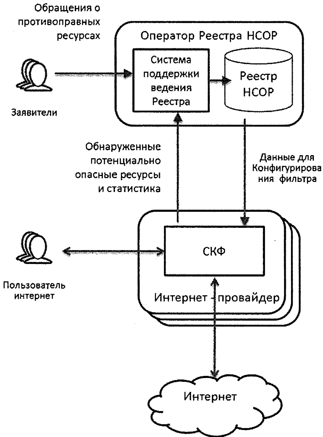
Рисунок 6. Принцип контроля доступа через Реестр НСОП
